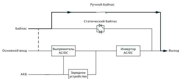
Рис. 1-10. Схема работы в режиме технического обслуживания
